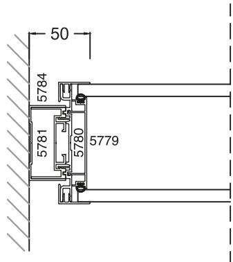
duvar - cam detayı
