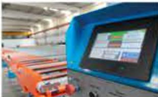
Kalıphane ünitemizden elde edilen kalıplar kullanılarak 1400 ve 2100 ton kapasiteli PLC sistemi ile çalısan extruzyon preslere sahip üretim hattımızda çeşitli sektörler için profiller üretilir.
