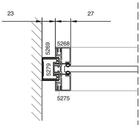
duvar - cam detayı
