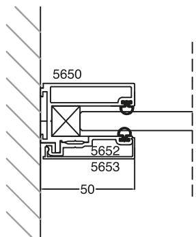
duvar - cam birleşim detayı
