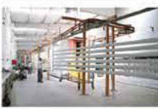
Kromat havuzlarında (kromsuz) yıkamadan geçirilen ürünlerimiz, otomatik sistem ile çalısan elektrostatik boyama ünitesinde ral renkler ve özel efekt renkler dahil olmak üzere, her renge boyanır.
