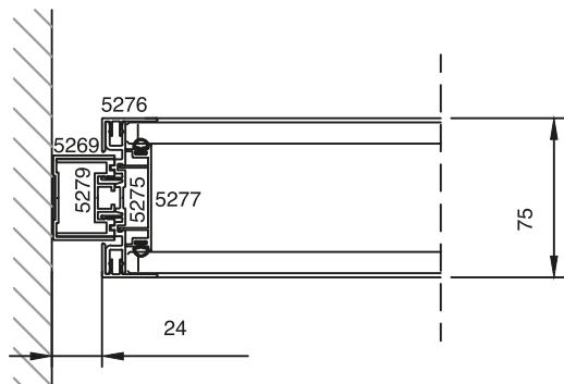
duvar - cam detayı
